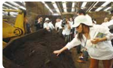
下水汚泥に弱酸性の発酵副生バイオマスを混ぜることで中和され、アンモニア臭低減の効果も
